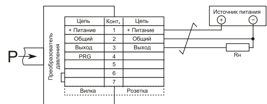
Схема подключения преобразователей с разъемом 2RMDT 1857Ш1В1В, контакты 6 и 7 вилки соединены перемычкой
